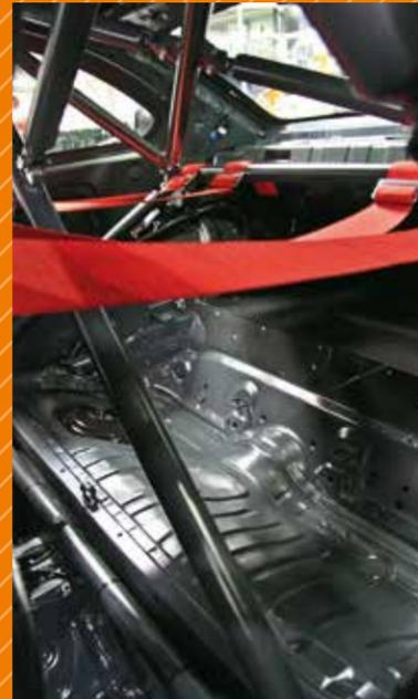
Ausgebaut: Die Rückbank fiel der Sicherheits-Vollzelle zum Opfer.
